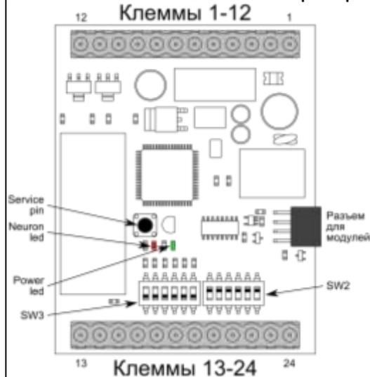
**Service pin** — кнопка для отправки Neuron ID в сеть LonWork. В нажатом положении загорается Neuron led.
